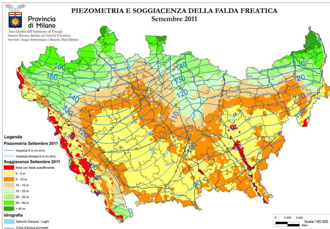
Figura - Piezometria e soggiacenza Settembre 2011 (Provincia di Milano, Servizio Acque Sotterranee e Banca Dati Idriche, SIF)
