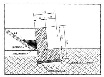
Come mostrato in Figura i gabbioni saranno realizzati in maglia 8X10, di filo zincato e plasticato Ø2.70/3.70mm. Inoltre tutti gli elementi sono costituiti da rete metallica a doppia torsione e maglia esagonale tessuta con trafilato di ferro a forte zincatura conforme alle norme UNI 8018 ed alla circolare del C. S. LL. PP. N 2078 del 27/08/1962 vigenti in materia e rivestito in speciale P.V.C.
