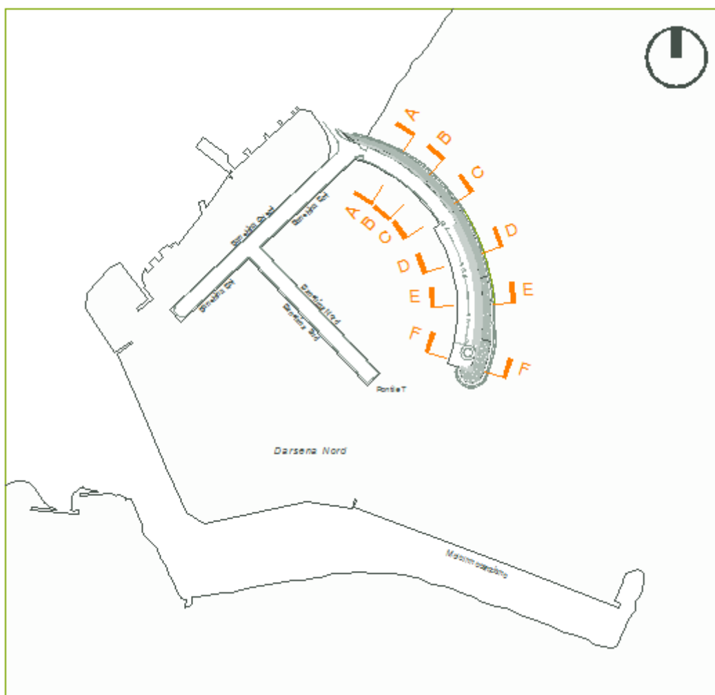
Figura10: Pianta chiave con posizionamento delle sezioni di progetto per la diga sottoflutto da realizzarsi durante la Fase2
