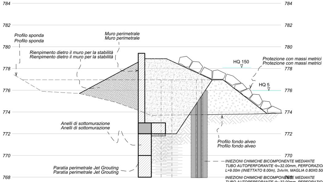
1. SCAVO PROGRESSIVO PER REALIZZAZIONE ANELLI DI SOTTOMURAZIONE
