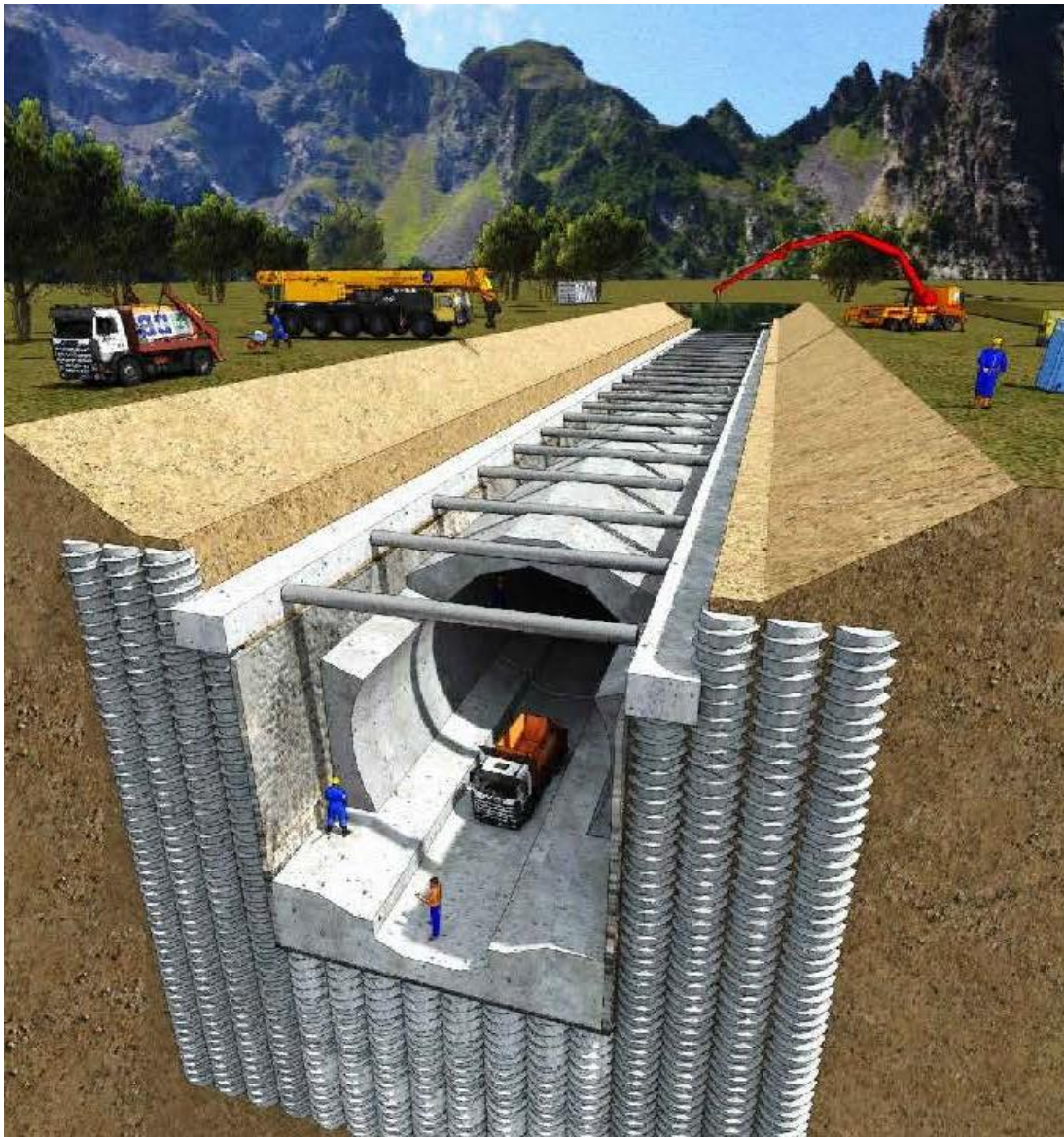
Abbildung 20: Aushubphase der Tunnel in offener Bauweise
