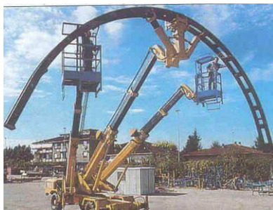
Abbildung 38 – Maschine zum Einbau von Lehrgerüsten im Tunnel
