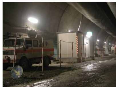
Illustrazione 4 – Mezzo di soccorso per l'utilizzo in atmosfere esplosive
