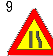
FIG. II 386 Art.31 STRETTOIA ASIMMETRICA A DESTRA Presegnala un restringimento pericoloso della carreggiata posto sul lato destro per la presenza di un cantiere stradale. ABBILDUNG II 386 Art.31 FAHRBAHNVERENGUNG (RECHTSSEITIG) Das Gefahrenzeichen weist auf eine gefährliche Verengung der Fahrbahn auf der rechten Seite wegen einer Straßenbaustelle hin.
