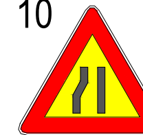
FIG. II 385 Art.31 STRETTOIA ASIMMETRICA A SINISTRA Presegnala un restringimento pericoloso della carreggiata posto sul lato sinistro per la presenza di un cantiere stradale. ABBILDUNG II 385 Art.31 FAHRBAHNVERENGUNG (LINKSSEITIG) Das Gefahrenzeichen weist auf eine gefährliche Verengung der Fahrbahn auf der linken Seite wegen einer Straßenbaustelle hin.
