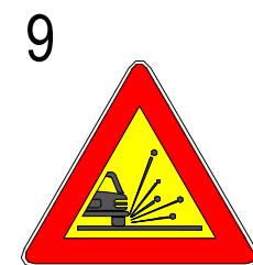
FIG. II 390 Art.31 - MATERIALE INSTABILE SULLA STRADA
