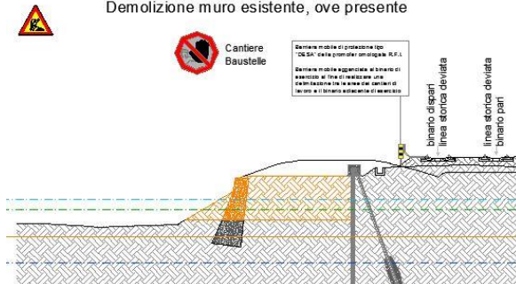
4a FASE - Scavo di approfondimento (H=3.00 m); Demolizione muro esistente, ove presente
