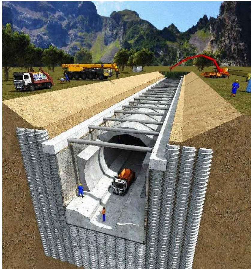
Foto 1: esempio di galleria artificiale
