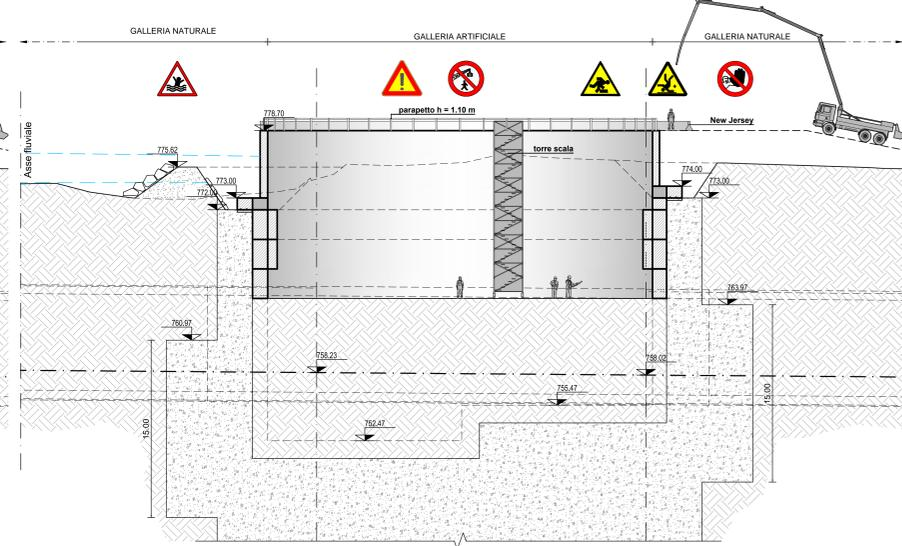
1. Scavo e realizzazione del terzo anello eseguito per sottomurazione h=2.50 (gli anelli di sottomurazione vanno eseguiti progressivamente per un'altezza di 2.50 m fino a quota intradosso soletta di fondazione)
