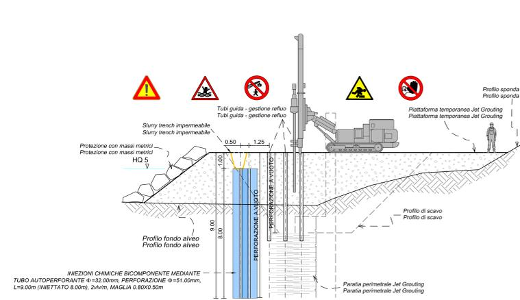
1. Realizzazione argine provvisorio e piattaforma temporanea jet-grouting
