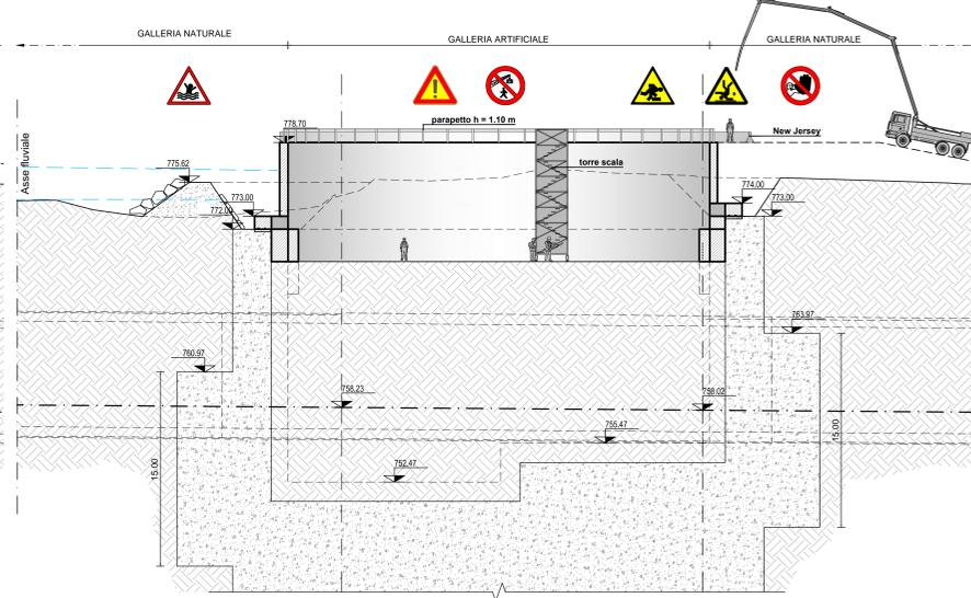
1. Scavo e realizzazione del primo anello eseguito per sottomurazione h=2.50
