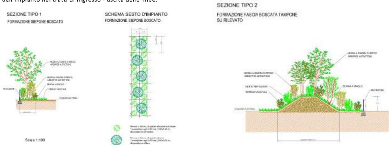
Figura 7-1- Formazione siepone boscato: sezione tipo e sesto d'impianto
