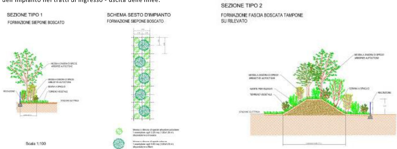
Figura 7-2 - Formazione fascia boscata tampone su rilevato
