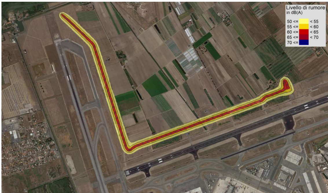
Figura 7-18 Curve di isolivello acustico indotte dal trasporto dei materiali nel periodo notturno
