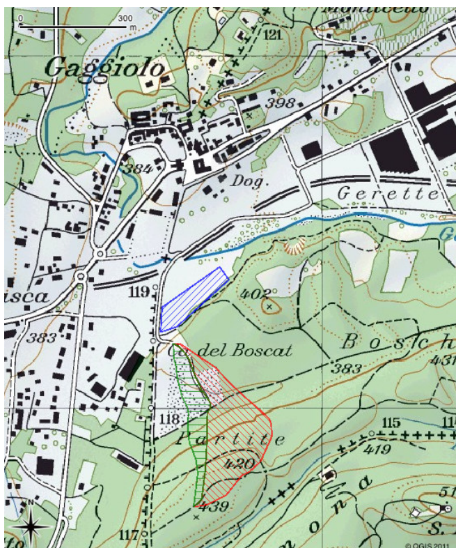
Figura 10: Superfici occupate dal progetto di tappa 3. In blu: superficie di occupazione temporanea per il riciclaggio ed il deposito provvisorio di materiali inerti (14'000mq), in rosso: nuova superficie occupata dalla discarica (49'400mq), in verde: superficie occupata dalla discarica di tappa 3 sovrapposta alle tappe precedenti (18'200mq).
