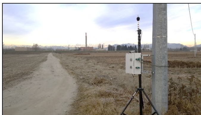
Figura 6-5 Stazione fissa di monitoraggio presso il punto ricettore
