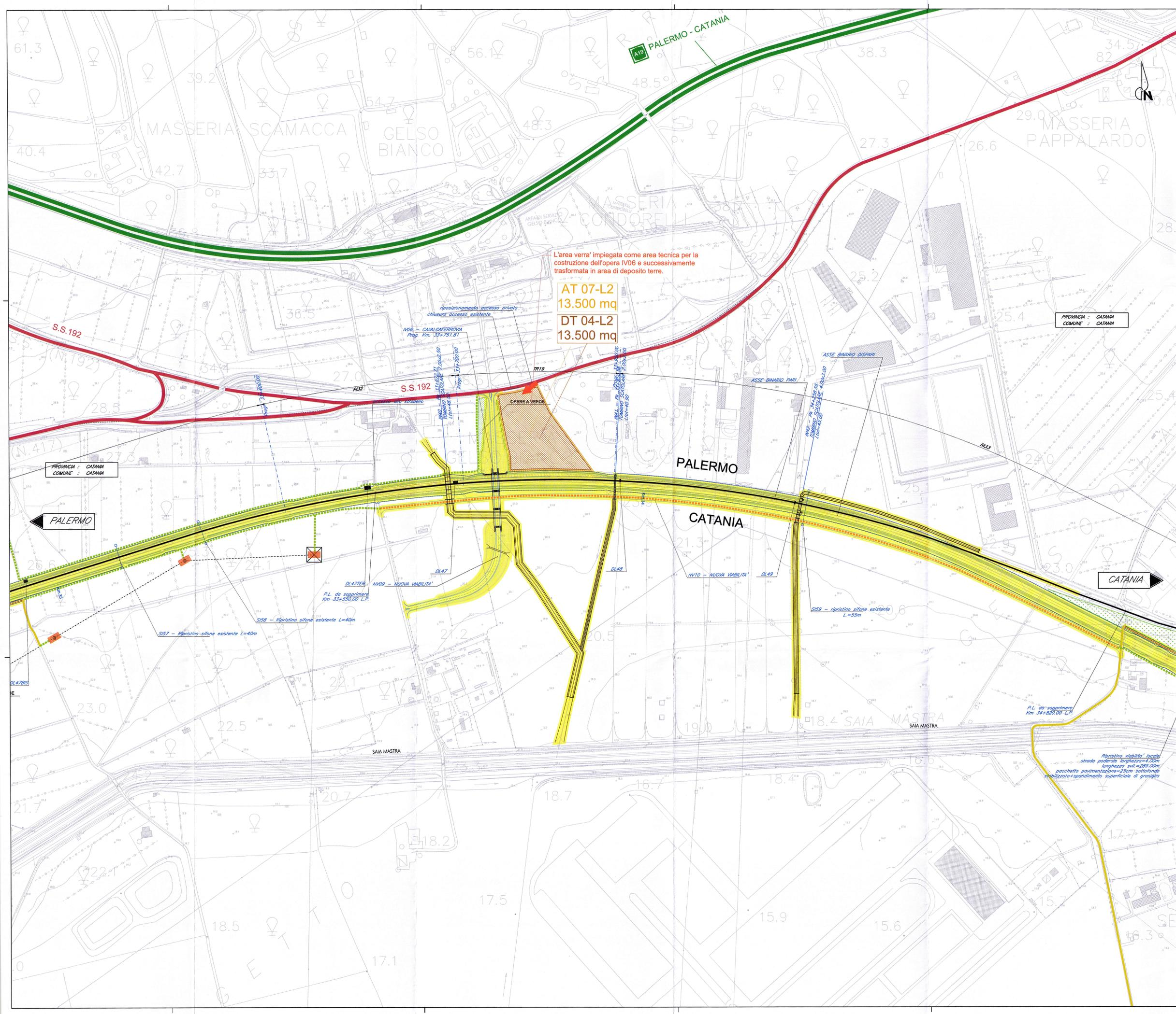
L'area verra' impiegata come area tecnica per la costruzione dell'opera IV06 e successivamente trasformata in area di deposito terre.
