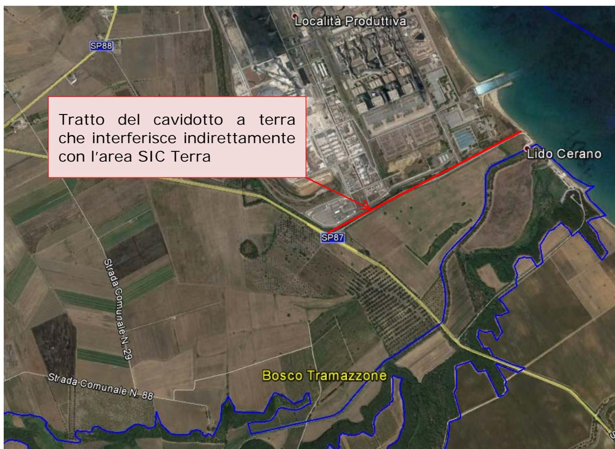
**Fig. 3-1 Inquadramento territoriale del cavidotto rispetto alla Centrale Enel e l'area SIC Terra**
