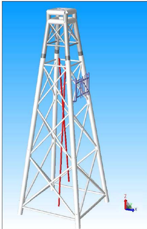
Fig. 2-11 Vista d'assieme della fondazione (in bianco il jacket, in rosso i due J-tube, in grigio il deck, in blu la struttura del boat landing)
