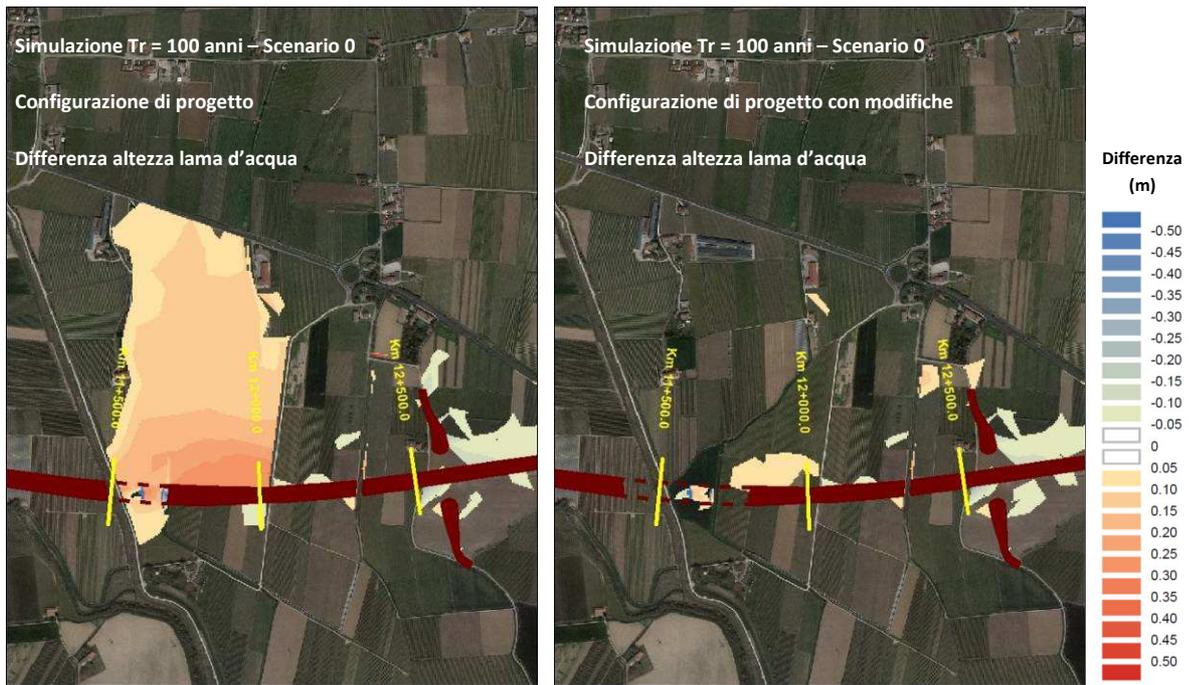
Fig. 2.2 - Evento con Tr=100 anni: differenze tra le altezze massime di allagamento valutate nel tratto di interesse (km 11+500 – km 12+100) in assenza di rotte (scenario 0) per le situazioni attuale e di progetto (a sinistra) e per le situazioni attuale e di progetto modificato (a destra).
