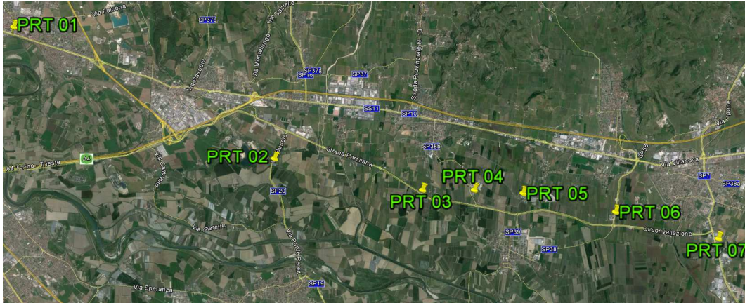
Figura 8-7: Sezioni di indagine sui flussi veicolari (Sezioni 1-7)
