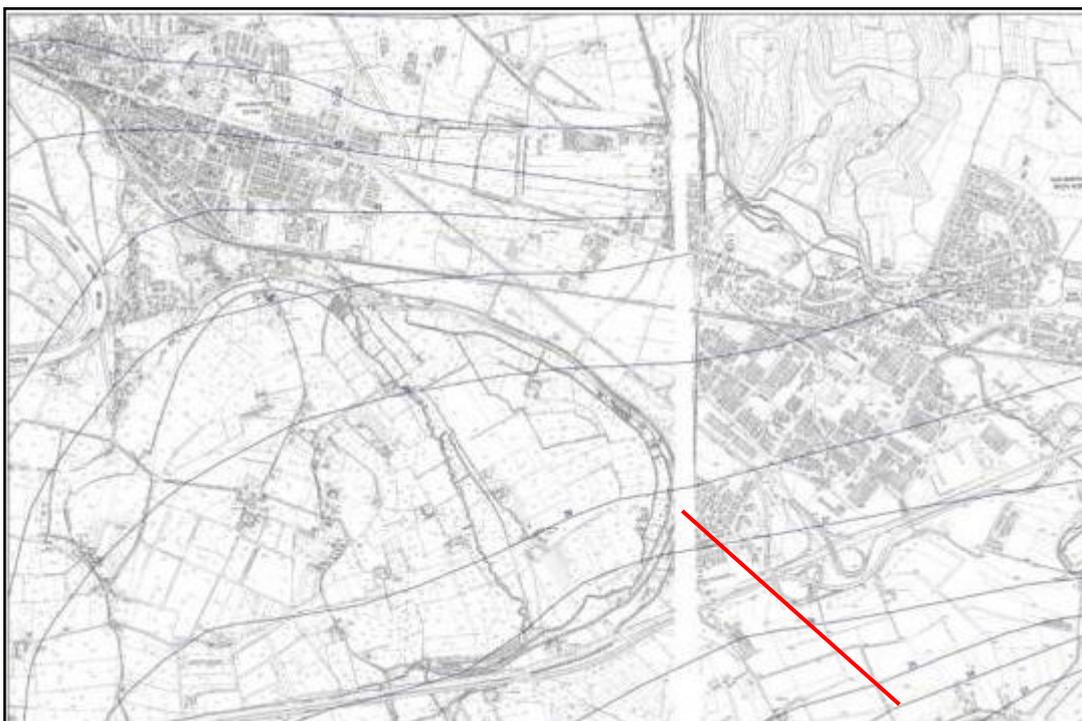
Figura 5- 15 – Superficie piezometrica (tratta da PTCP della Provincia di Verona). In rosso è riportato il tratto di galleria in progetto).
