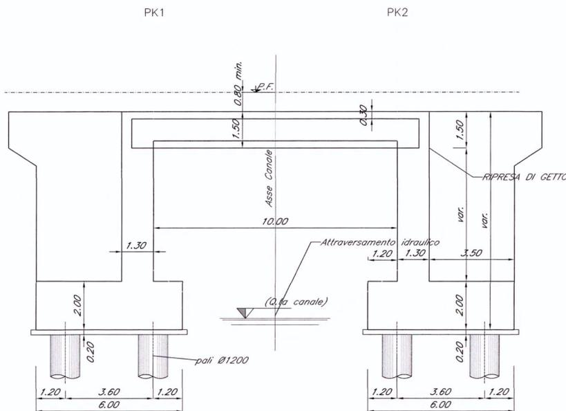
DIREZ. NORD PROSPETTO/SEZIONE LONGITUDINALE BINARIO PARI - Scala 1:500 - LINEA AV/AC
