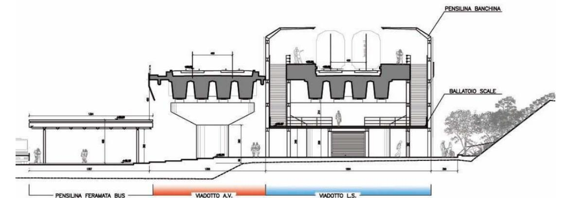
Le banchine saranno raggiungibili tramite collegamenti verticali costituiti da scale e doppi ascensori. La pavimentazione in pietra naturale antiscivolo, con bordi e finiture in travertino.
