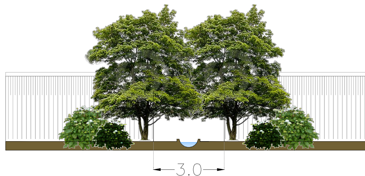
Prospetto tipo – Imbocco Sottopasso faunistico
