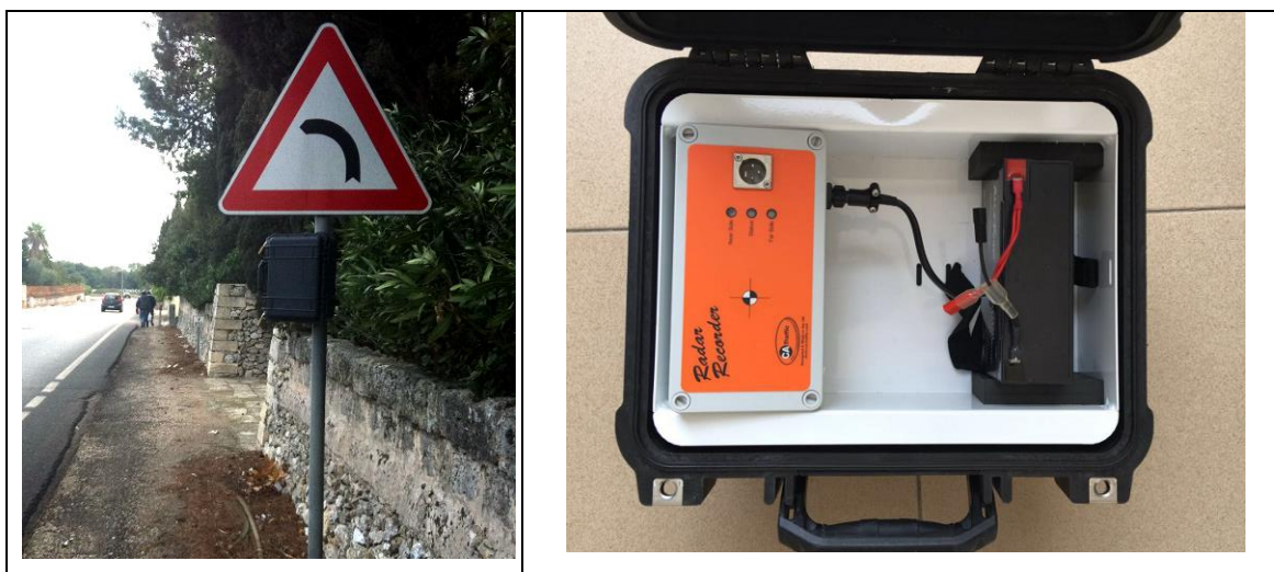
Figura 3 Strumentazione per il rilevamento del traffico
