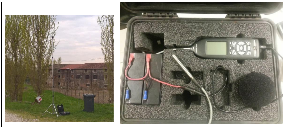
Figura 2 Strumentazione per il rilevamento del rumore
