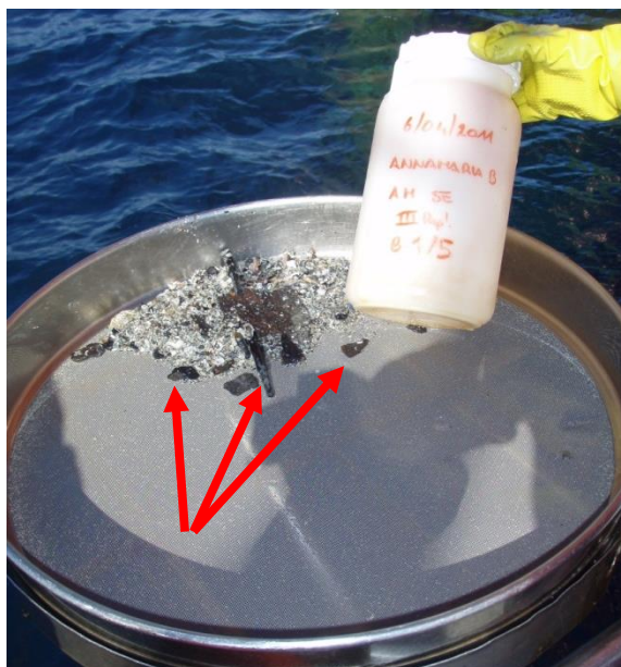
Fig. 4.1 – 2° survey post lavori (inverno 2011). Campione di benthos prelevato dal sito AM SE. Le frecce indicano pezzi di ferro rinvenuti nel campione.
