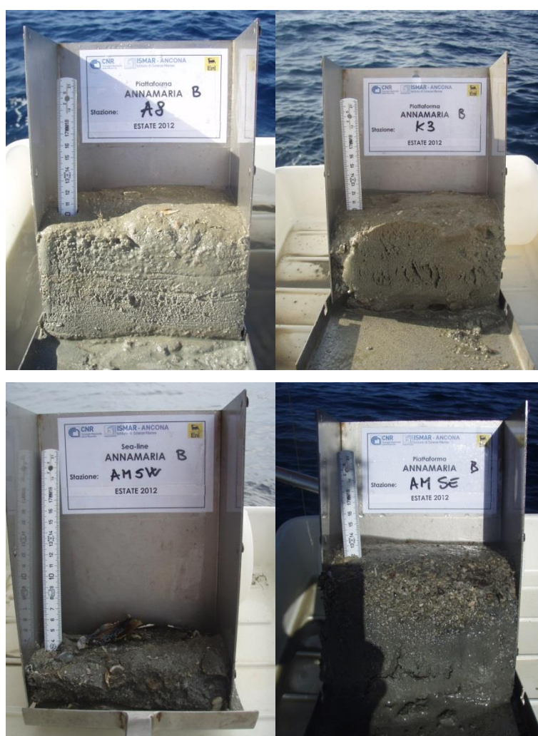
Fig. 3.16 - Campioni di sedimento prelevati nell'estate 2012 presso un sito posto a 250 m dalla piattaforma (A8) un controllo (K3), e in due stazioni situate corrispondenza della struttura (AM SW e AM SE).
