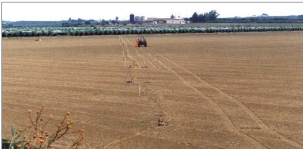
Figura n. 16: Esempio di pattern di geofoni, che prevede gruppi di 12 geofoni distanti fra loro 2,27 m, per una lunghezza totale del pattern di 25 m
