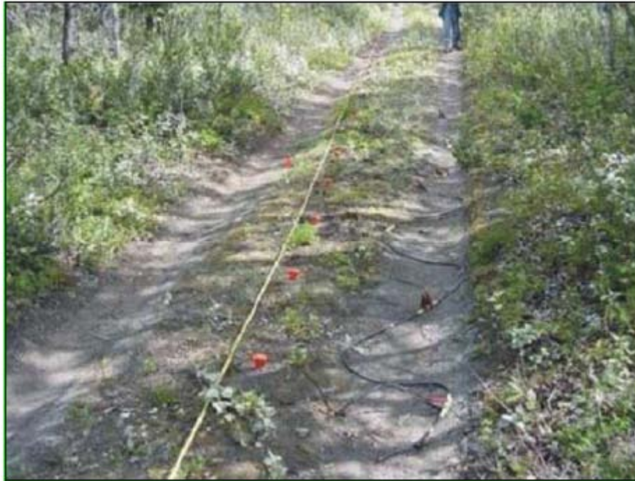
Figura n. 21: Esempio di stendimento geofoni su strada sterrata
