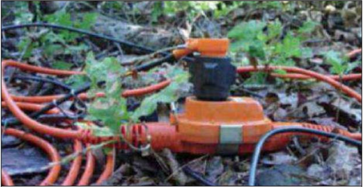
Figura n. 13: Posizionamento dei geofoni
