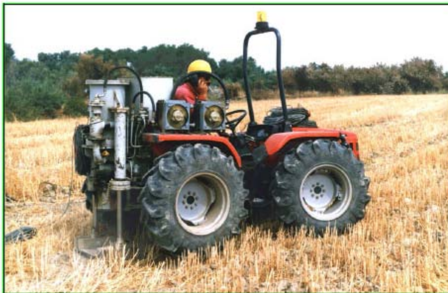
Figura n. 10: Vibroseis leggero montato su mezzo agricolo operativo in area appenninica
