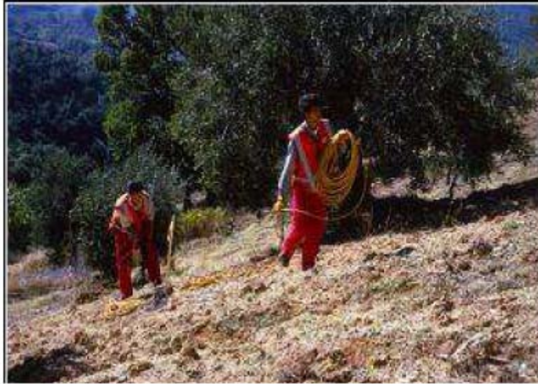
Figura n. 18: Stesura dei cavi, dei geofoni e della strumentazione
