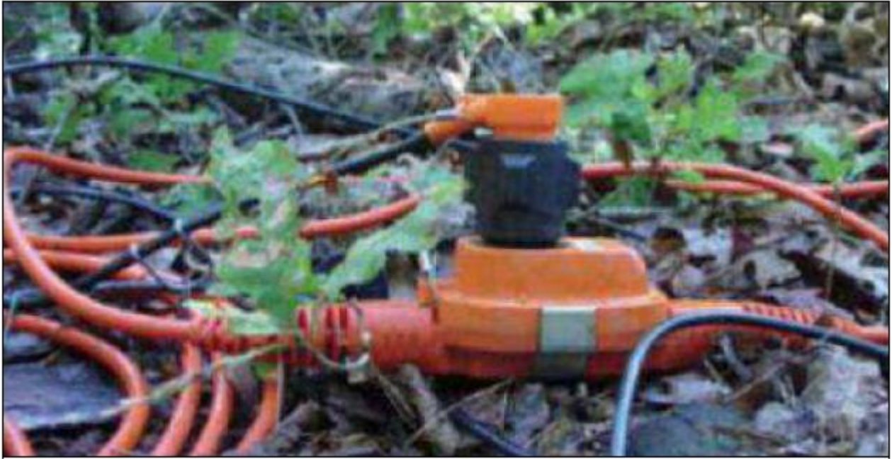
Figura n. 24: Posizionamento dei geofoni
