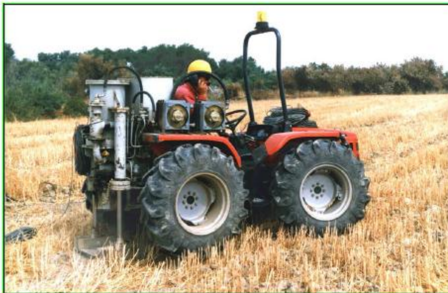
Figura n. 21: Vibroseis leggero montato su mezzo agricolo operativo in area appenninica
