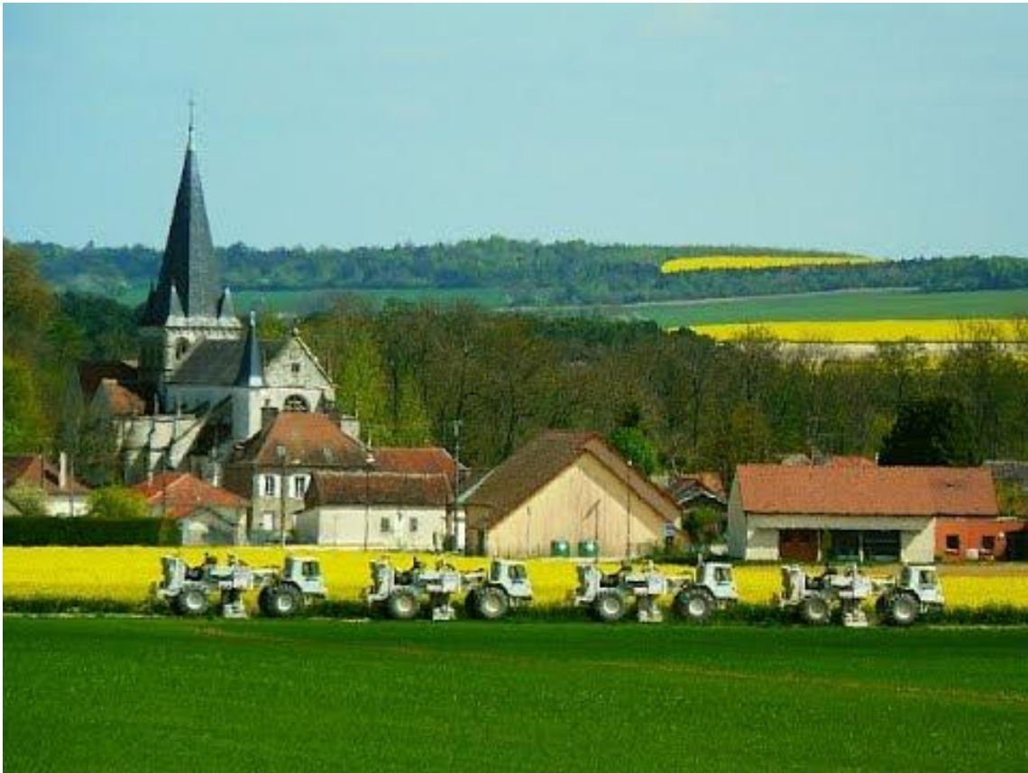
Figura n. 36: Esempio di utilizzo di Vibroseis in prossimità di beni architettonici
