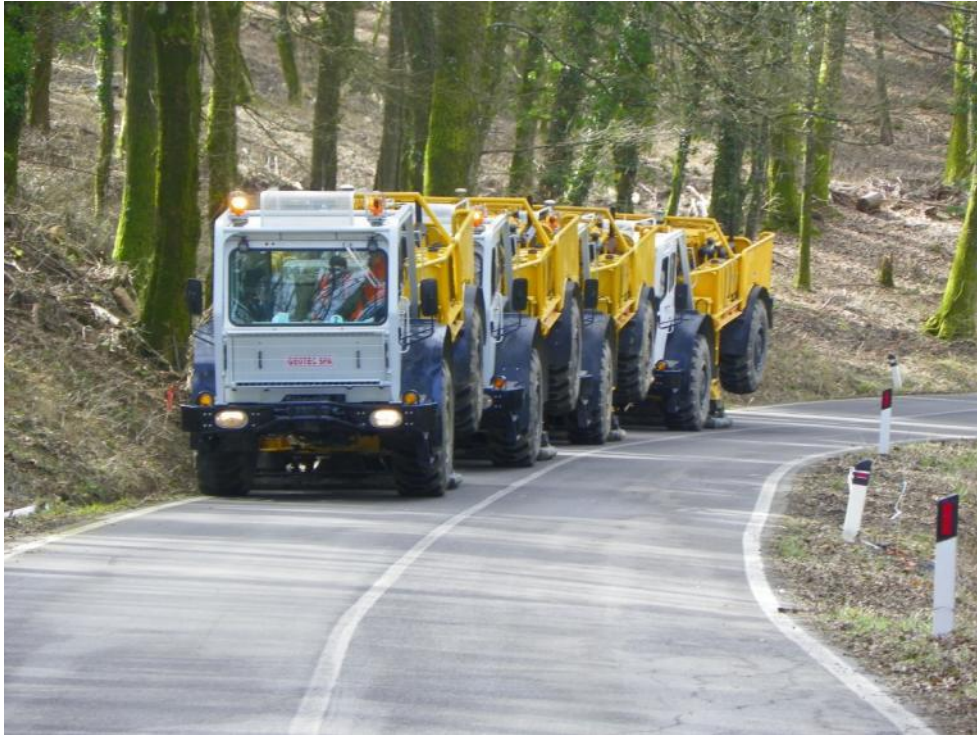
Figura n. 35: Esempio di vibratore predisposto per l'energizzazione del terreno
