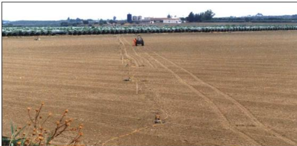
Figura n. 27: Esempio di pattern di geofoni, che prevede gruppi di 12 geofoni distanti fra loro 2,27 m, per una lunghezza totale del pattern di 25 m
