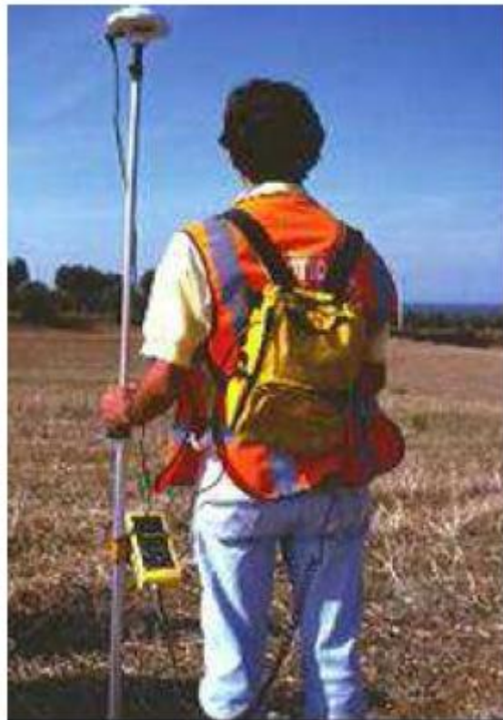
Figura n. 26: Rilievo topografico mediante uso di GPS
