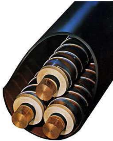
Figura 2-5 - Cavi con isolamento in carta impregnata di olio fluido contenuti in tubo d'acciaio
