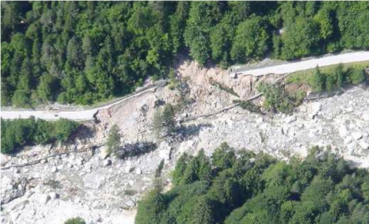
Figura 2-13- Esempio di frana su carreggiata stradale
