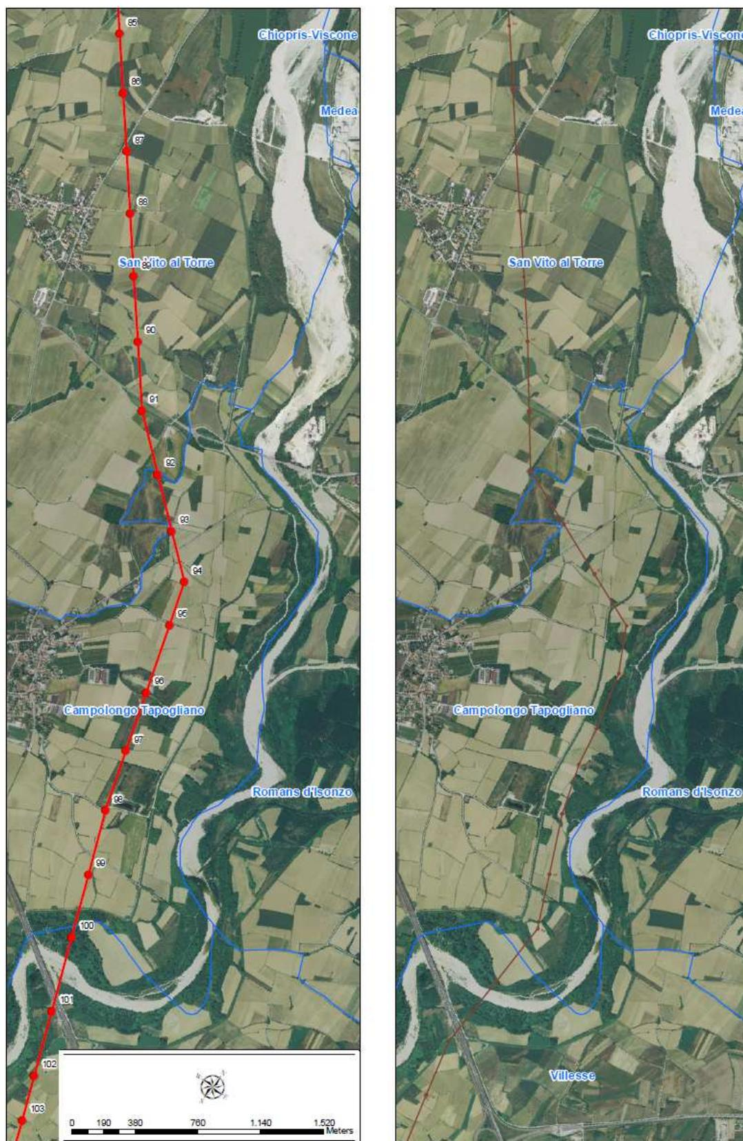
**Figura 1.1.5 – Confronto tra il tracciato del 2009 (in colore marrone sulla destra) ed il nuovo tracciato del 2012 (colore rosso 380 kV UdOvest-Redipuglia) S. Vito al Torre-Villesse**
