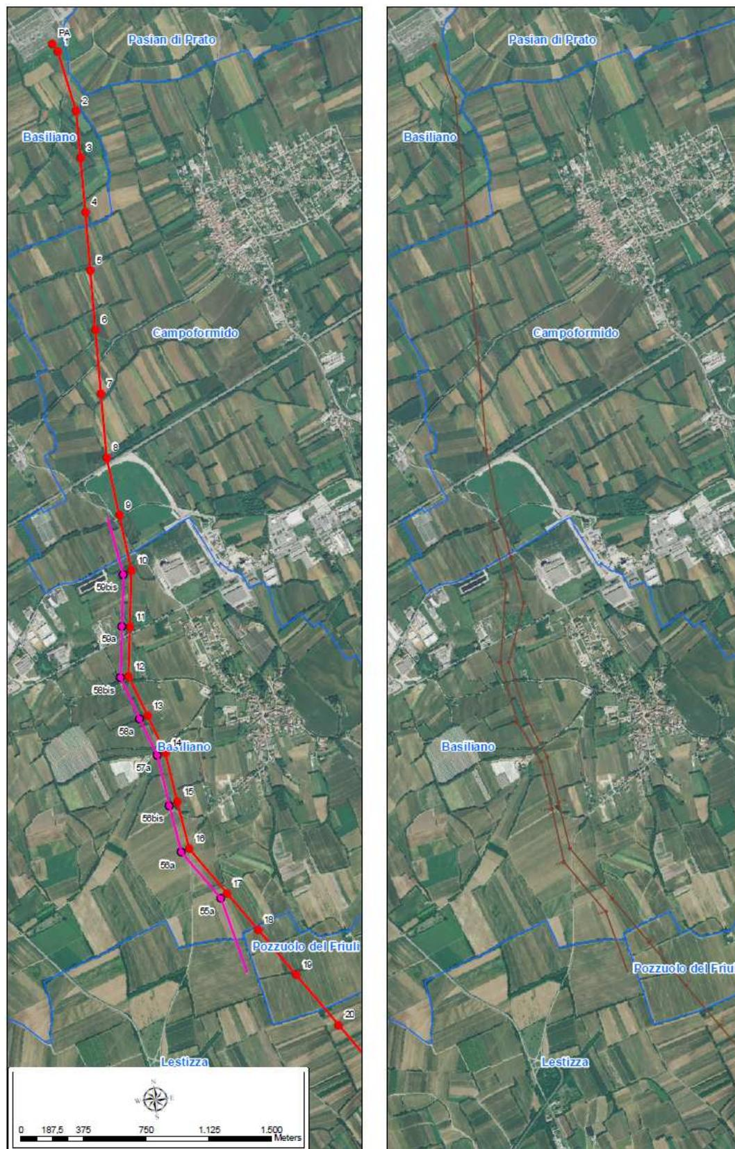
Figura 1.1.1 – Confronto tra il tracciato del 2009 (in colore marrone sulla destra) ed il nuovo tracciato del 2012 (colore rosso 380 kV UdOvest-Redipuglia, colore fuxia 380 kV Udine Ovest-Planais) Tratto Basiliano-Pozzuolo del Friuli
