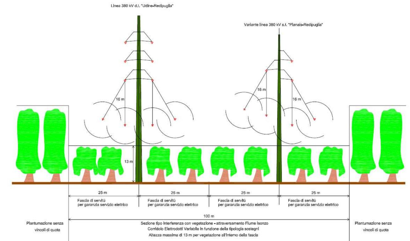
**Figura 6.1.1: Schema delle distanze di taglio e di piantagione delle essenze arboreo arbustive**
