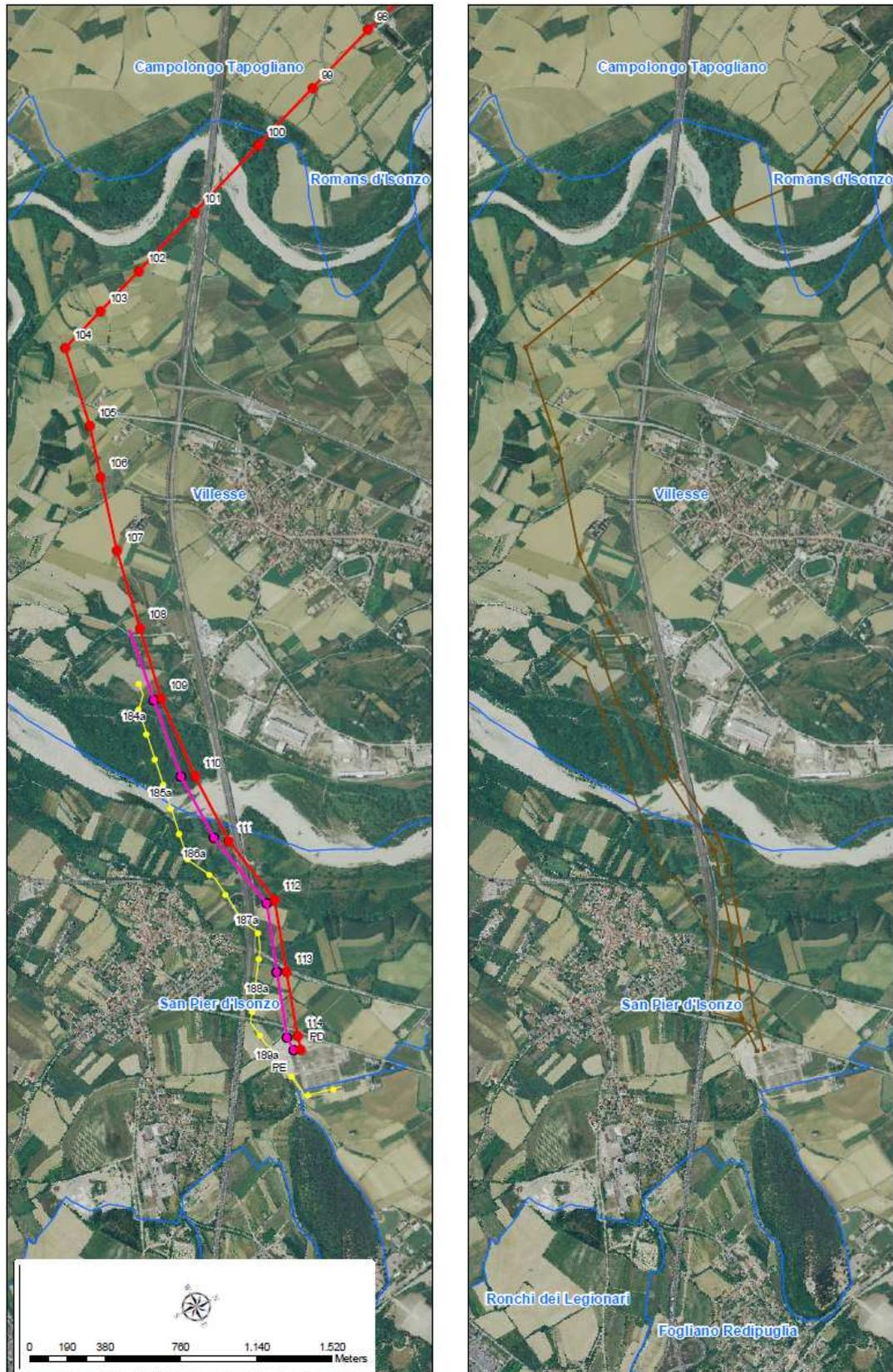
Figura 1.1.6 – Confronto tra il tracciato del 2009 (in colore marrone sulla destra) ed il nuovo tracciato del 2012 (colore rosso 380 kV UdOvest-Redipuglia, colore fuxia 380 kV Redipuglia-Planais e in giallo il tratto in cavo interrato a 132kV) Villesse-S. Pier d'Isonzo
