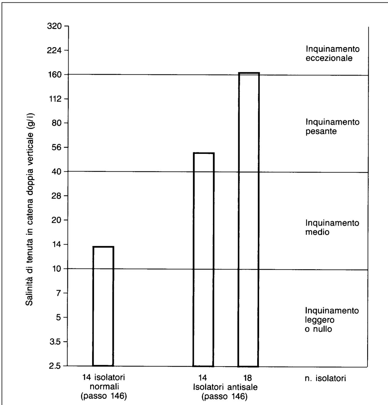
Le caratteristiche della zona interessata dall'elettrodotto in esame sono di inquinamento atmosferico medio e quindi si è scelta la soluzione dei 14 isolatori (passo 146) tipo J1/2 (normale) per tutti gli armamenti in sospensione e quella dei 14 isolatori (passo 146) tipo J1/2 (normale) per gli armamenti in amarro.
