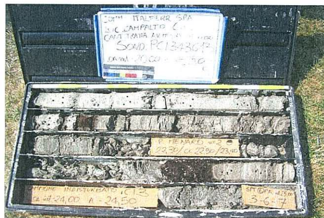
Fig. 9.3 – Foto carotaggi a quota galleria (G05 - G13)
