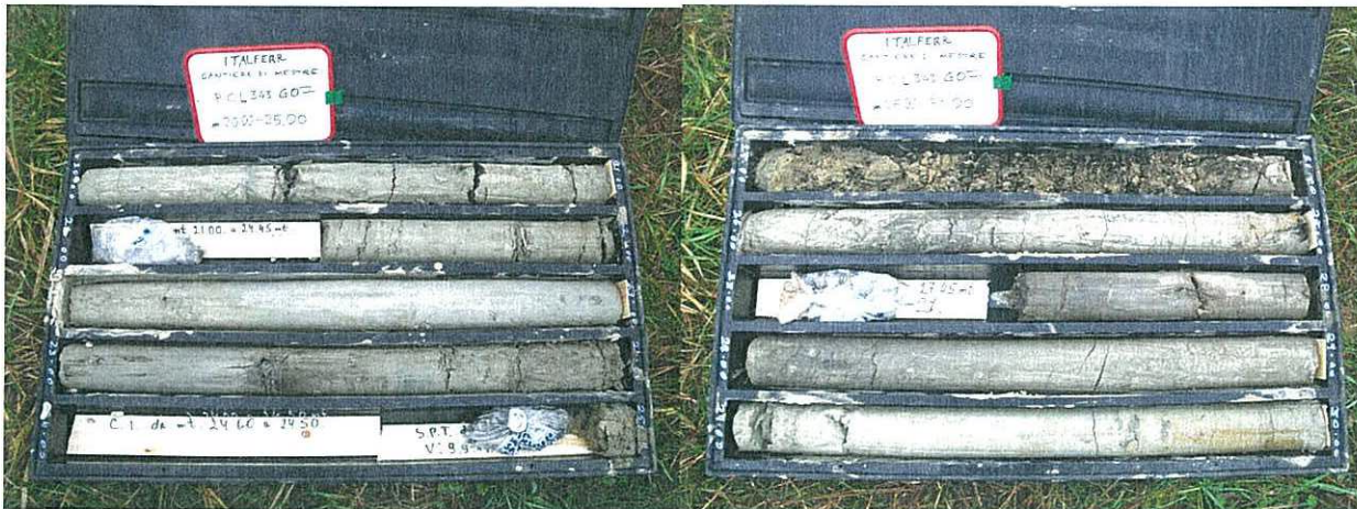
Fig. 9.2 – Foto carotaggi a quota galleria (G02 - G07)
