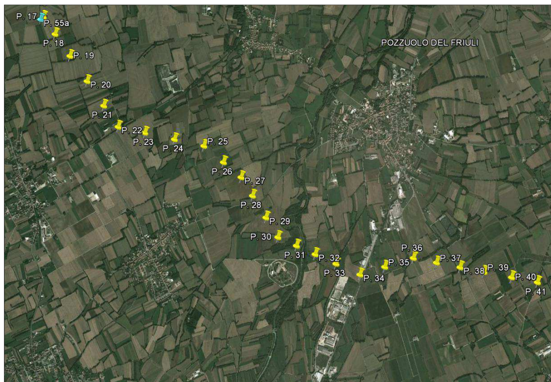
Figura 3.2: Inquadramento su foto satellitare delle aree interessate dall'intervento - seconda parte. Si notino la linea in progetto (in giallo) e la variante all'elettrodotto a 380 kV "Planais - Udine Ovest" in azzurro.
