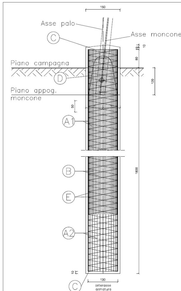
**Figura 4.4:** Schema tipo di fondazione profonda su pali trivellati per sostegni a traliccio.
