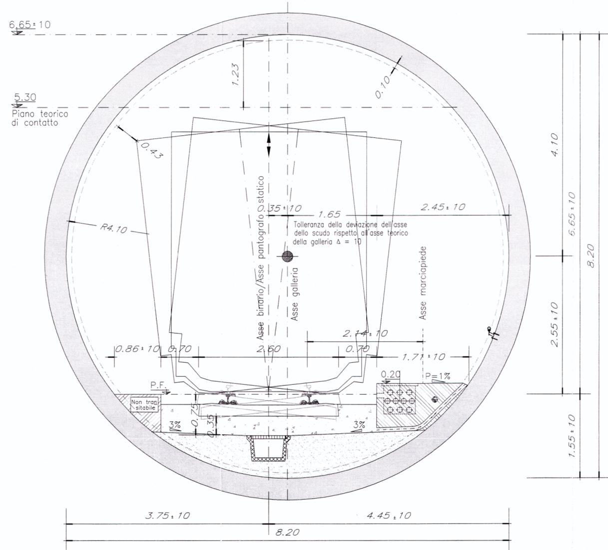
Sezione da Manuale di Progettazione, per velocità sino a 200 Km/h, modificata con un disassamento costante di 10 cm per accogliere le traverse da 2.60 m e predisposta per l'alimentazione a 25 Kv.
