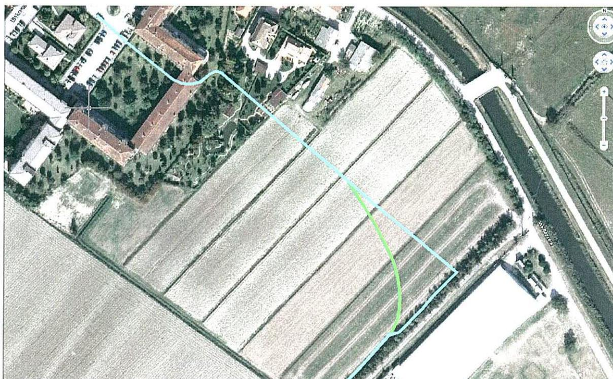
**Figura 5** Deviazione provvisoria prolungamento Collettore di Levante.
