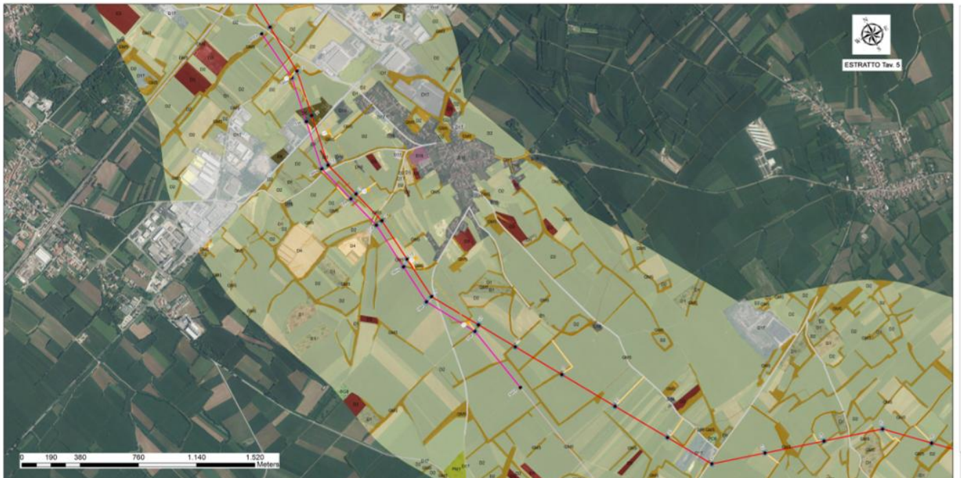
Figura 4.4: Tratto da demolire elettrodotto 380kV Planais - Udine Ovest - Redipuglia
