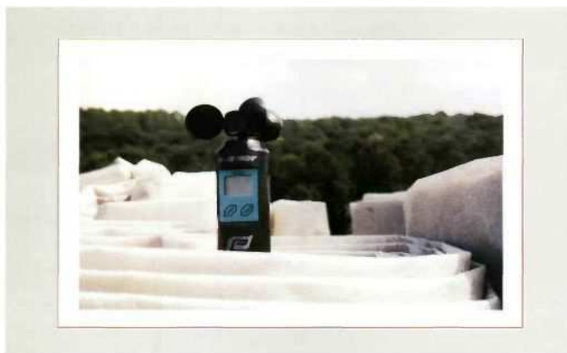
Anémomètre de « poche » permettant la mesure de la vitesse du vent sur le chantier.
