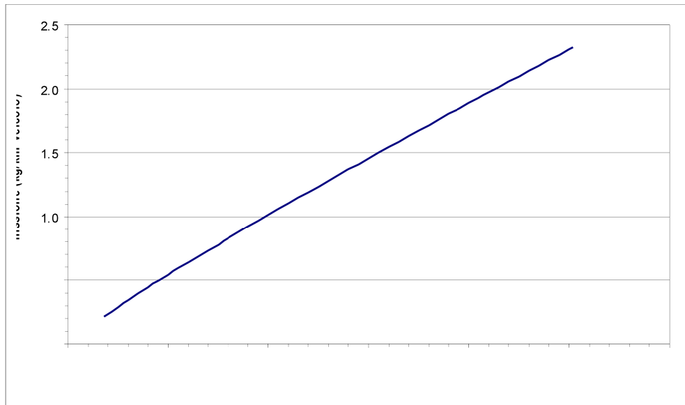
Figura 1: andamento del fattore di emissione per il PM10 al variare del contenuto percentuale di silt presente nel materiale su cui avviene il transito dei veicoli (avendo posto pari a 30 Mg il peso medio dei veicoli).
