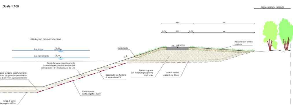
SEZIONE TIPO CANALE DI RESTITUZIONE
