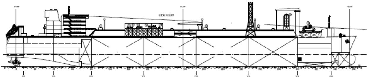
Il progetto proposto da D’Appolonia prevede la fornitura di 170,000 FSRU con un impianto di rigassificazione installato con una capacità di 500 MMSCFD
