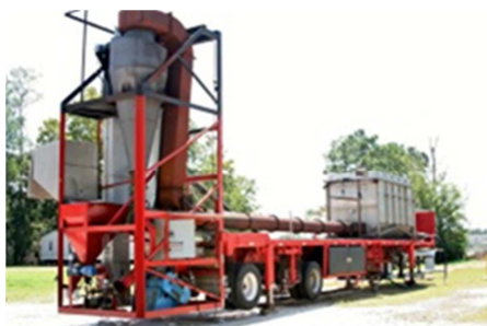
Figura 1: Fornace mobile per la preparazione della perlite espansa in sito
