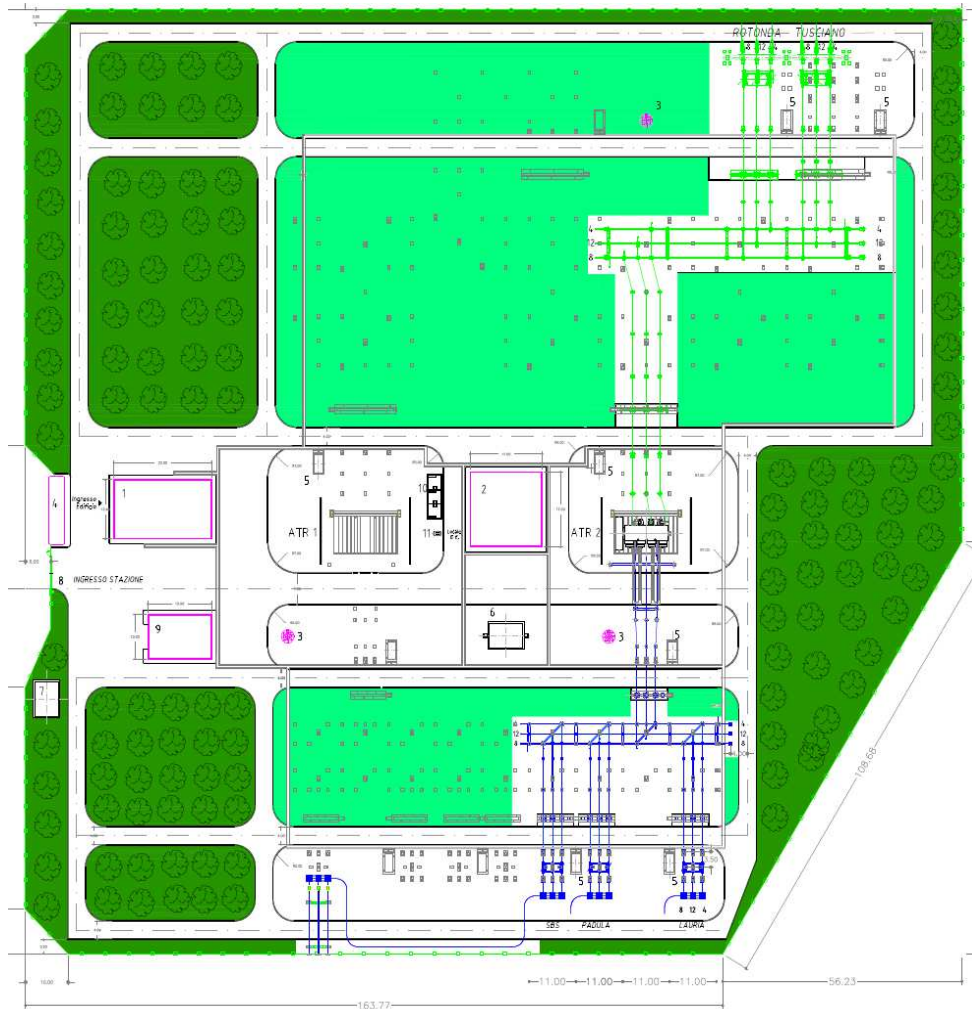
Figura 1: Planimetria elettromeccanica generale - Stazione in variante 220/150 kV
