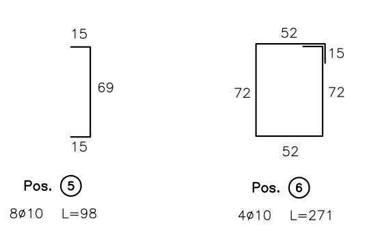
FONDAZIONE PER APPARECCHIATURE UNIPOLARI TG 2074/7
