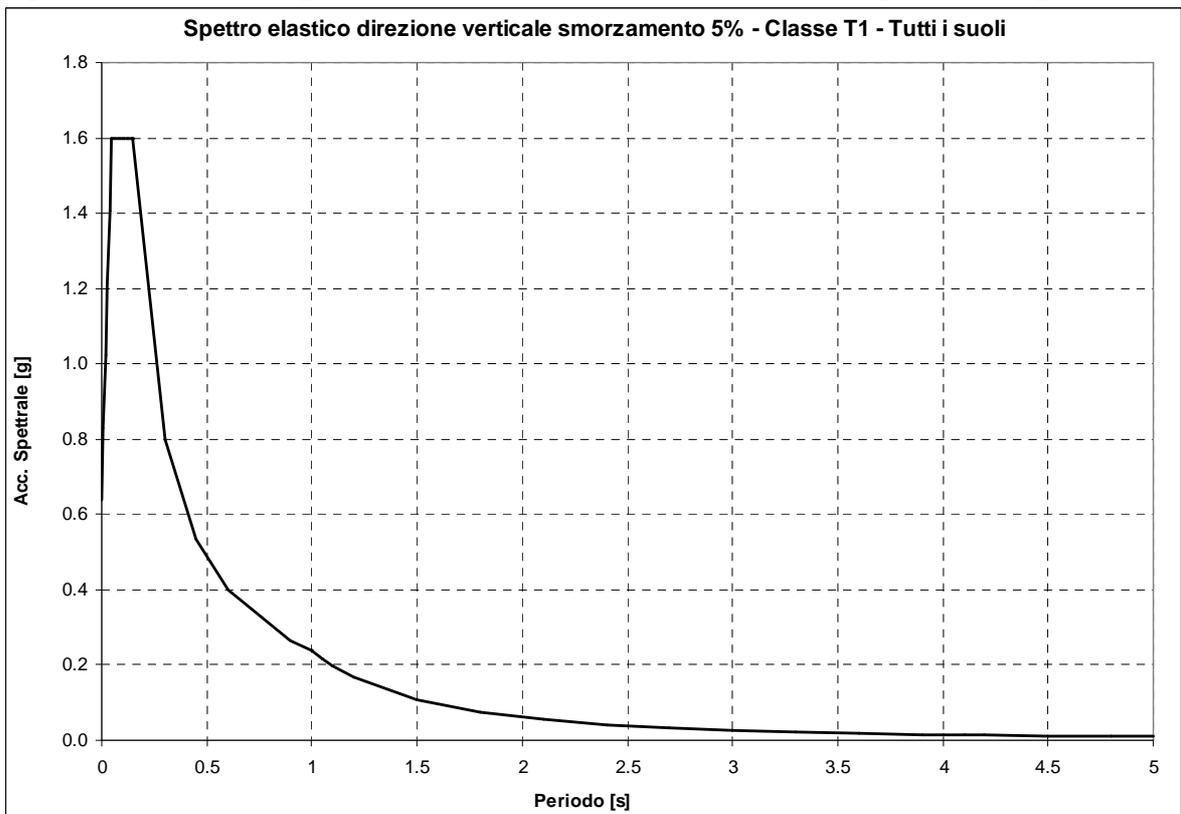
La necessità di installare le stesse apparecchiature e carpenterie in siti differenti, caratterizzati da condizioni del suolo e zone sismiche diverse ha reso necessario, con la vigente normativa, scegliere il periodo di ritorno più alto (2475 anni) e la classe topografica T1; poiché per la verifica si utilizza, per la
