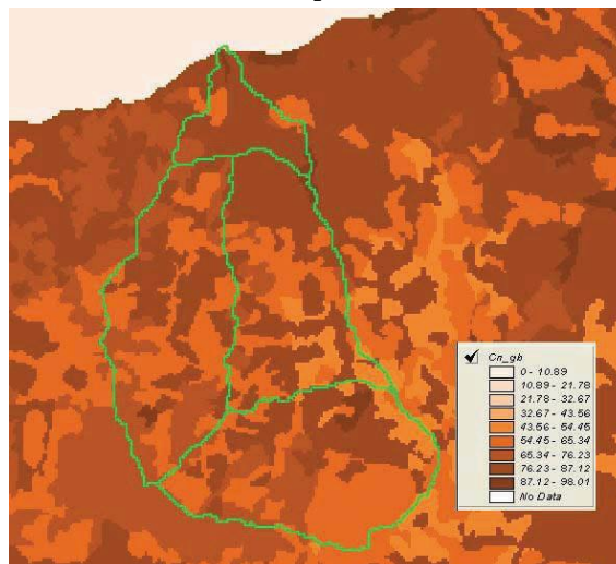
Fig. 3.9 DTM relativo alla distribuzione del parametro "CN" nel bacino del T.te Furiano
