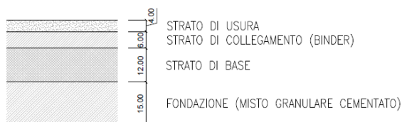
Figura 3.1.2 Particolare pavimentazione stradale
