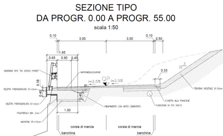
Figura 3.1.1 Sezione tipo piattaforma stradale
