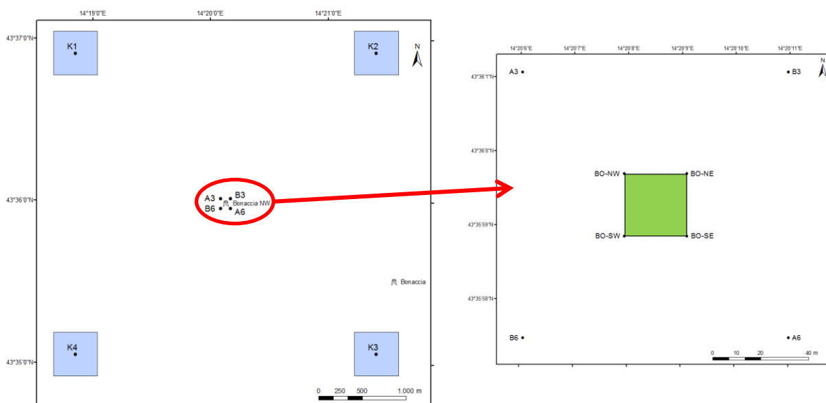
Fig. 2.4 - Schema di campionamento utilizzato per le indagini sedimentologiche e sulla comunità bentonica. A destra il particolare dei quattro siti di prelievo nel punto di installazione della piattaforma. In verde l'area occupata dalla struttura.
