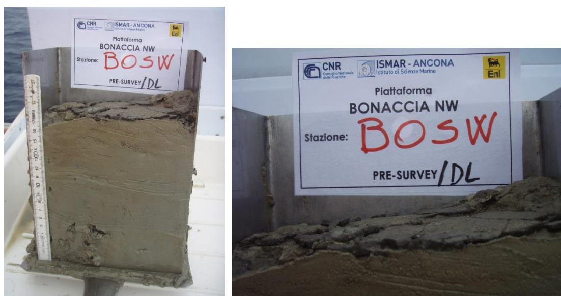
Fig. 3.54 - Campione di sedimento prelevato dal sito BO SW durante i lavori di installazione di Bonaccia NW. E' visibile in superficie lo strato di sedimento solidificato (dettaglio sulla destra).
