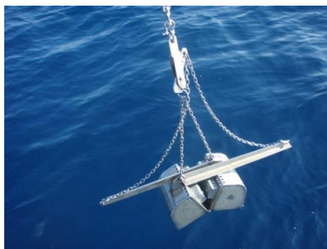
Fig. 2.7 – Benna Van Veen utilizzata per le indagini sulla comunità bentonica.
