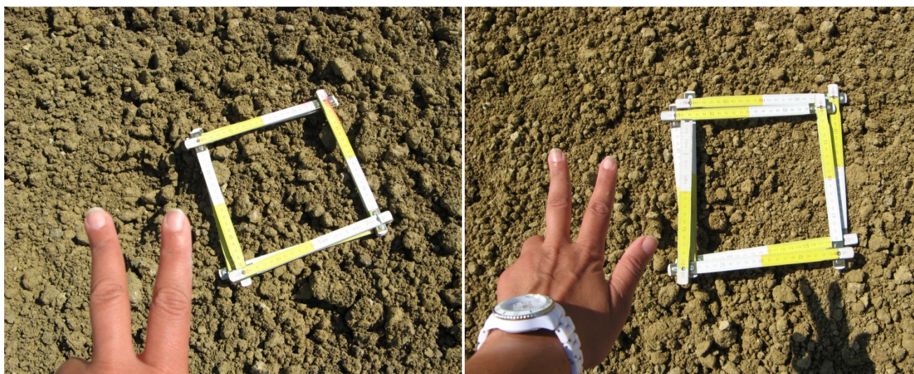
Figura 13 – Granulometria apparente delle miscele dopo due e tre passaggi di fresa
