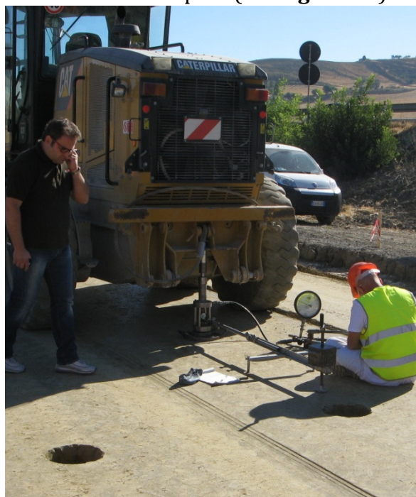
Figura 16 – Controlli di portanza con piastra dinamica (LWD) e prove di modulo di deformazione (Md)
