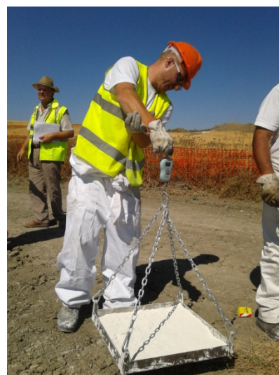
Figura 12 - Spandimento della calce e controlli
