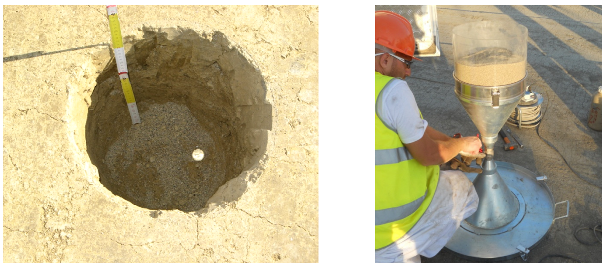
Figura 15 – Controlli di densità sull'intero spessore dello strato con volumenometro di grande diametro
