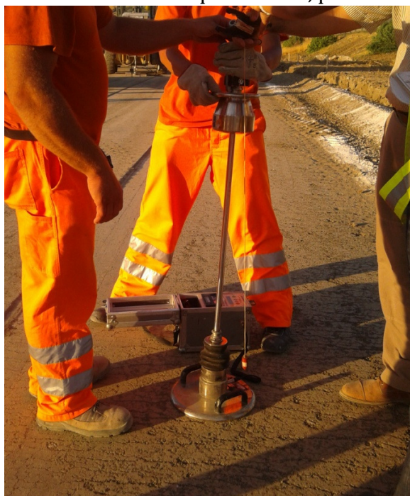
Figura 16 – Controlli di portanza con piastra dinamica (LWD) e prove di modulo di deformazione (Md)
