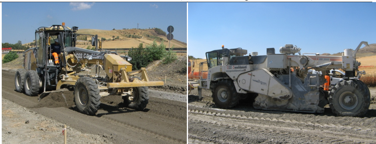
Figura 11 – Attrezzature per la stesa e la miscelazione della terra
